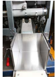
図1: 溶解ユニットをキャビネットの前に置きます。
